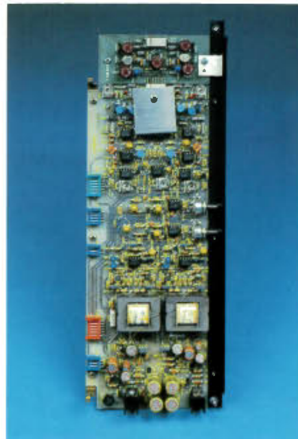
Das Bild zeigt die NF-Platine. Deutlich ist oben der aktive Impedanzwandler für dynamische Tonabnehmersysteme zu erkennen.
