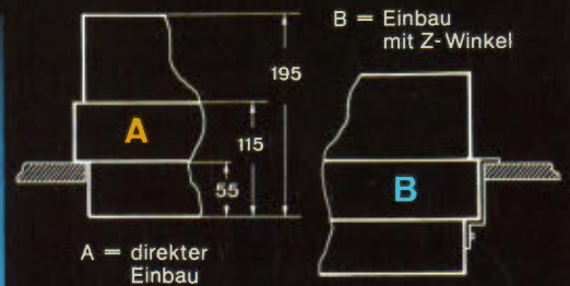
Der direkte Einbau in einen Ausschnitt (A) ist auf dem Titelblatt zu sehen.
