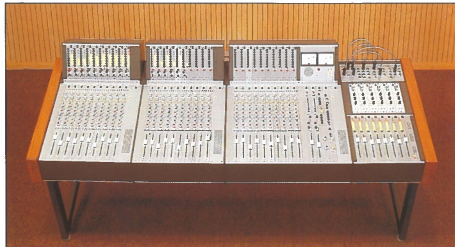
Werden 30 Eingangskanäle benötigt, so kann das Mischpult diese Form haben. Auch hier erkennt man rechts den Fader-Kompressorrahmen.
