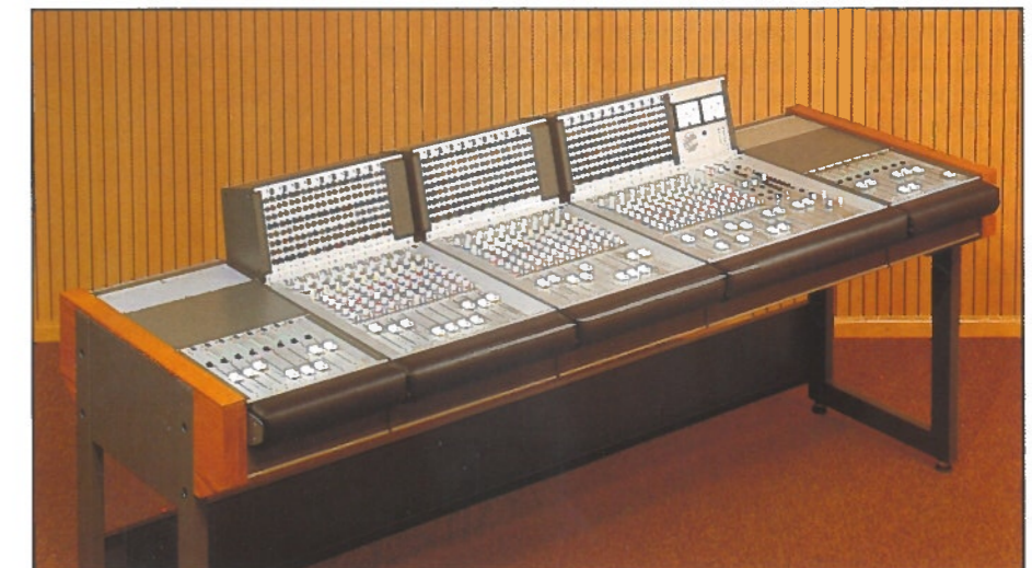
30 Eingangskanäle und 2 Fader-Kompressorrahmen – je einer an jeder Seite – stellen eine Maximalbestückung dar, die fast jeder Anforderung genügen dürfte.
