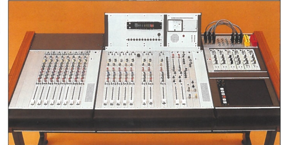
Mit diesem Pult produziert eine bundesdeutsche Rundfunkanstalt Werbespots. Es enthält 8 Mikrofoneingänge und 8 Stereoeingangseinheiten.
